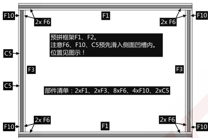
15. 图示为组成下部框架部件的预拼位置，注意 F6、F10、C5 应预先滑入相应位置型材的侧面凹槽内。
