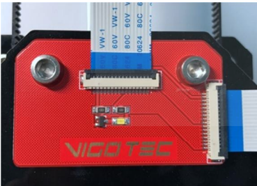
11. 转接板 C3 接线完成后。
