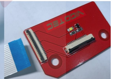
6. 转接板 C2、C3 的排线口均为翻盖式。先将锁扣向上翻起。
