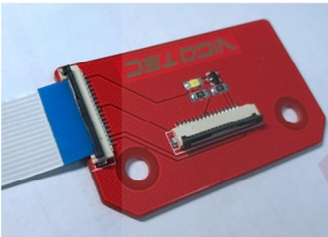
7.插入排线 注意排线金属触点往下。
